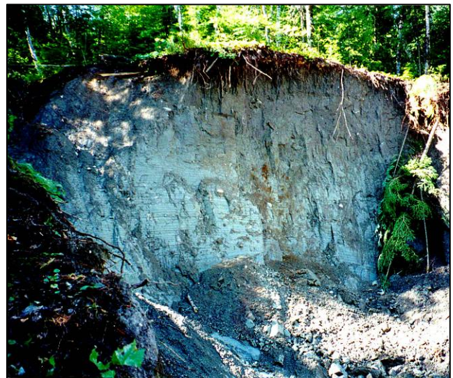
Figure 7 – Vue de l'escarpement arrière du glissement. À noter les fines strates visibles dans la partie à gauche.
